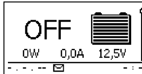
Abb. 4: Display nach dem Einschalten der externen Batteriesicherung
